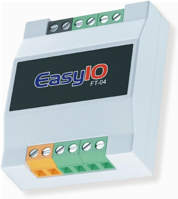
FT-04产品系列是一款外形小巧的多功能控制器。该控制器仅限在有Wi-Fi连接的情况下使用，可将控制范围扩展至难以触及的设备，可在狭小空间内使用，可用于局部照明控制、远程输入/输出、温度控制及监控、设备开/关控制、住宅应用或任何需要连接的应用等。
